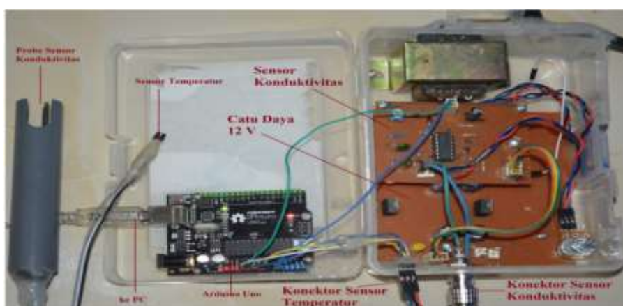
Gambar 4 Rangkaian Keseluruhan Alat Ukur TSS Air
