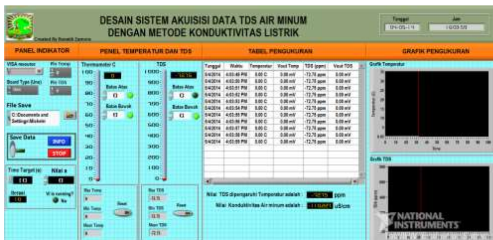
Gambar 5 Tampilan Program LabView untuk Pengukuran TDS Air
